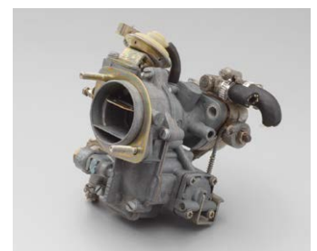
Puhdistettu kaasutin Elmasonic S80-pesurilla ja Elma Tec Clean A5-pesuaineella
